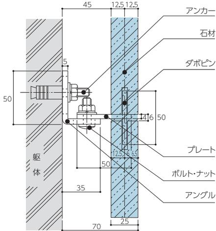
中高層階(3階以上)の外壁に適した工法です。
