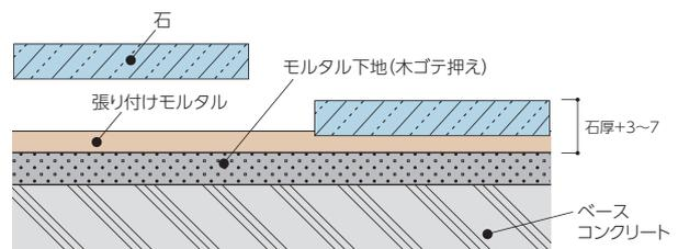
ベースコンクリート面に精度の良いモルタル下地を作ります。養生した後に張り付けモルタルを塗り付け、石をゴムハンマー等で十分にたたき押さえます。
