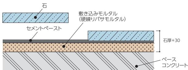
硬練りバサモルタルを敷き込みその上に石を仮置きして、ゴムハンマー等でたたき込み面調整をします。一旦、石を取り除きセメントペーストをまんべんなく塗布して再びゴムハンマー等で十分にたたき押さえます。
