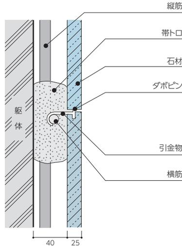
低層階(2階以下)の外壁、内装の壁に適した工法です。
